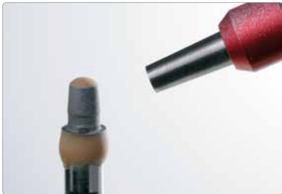
Die Herstellerangaben des Implantatatherstellers sind zwingend zu beachten. Vorsichtiges Abstrahlen der Klebefläche mit max. 50 µm bei 1–2 bar.
