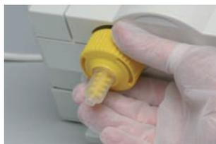
ダイナミックミキサー、ロッキングリングの順で取り付けて使用する。
