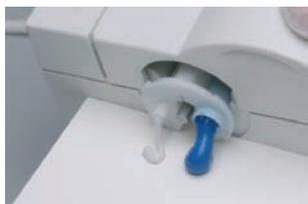
自動練和器にカートリッジをセットし、2カ所から材料が出るのを確認する。
