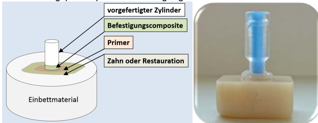
Abb. 4: Schematische Abbildung und Beispiel eines Prüfkörpers für die Scherhaftprüfung von Befestigungsmaterialien.
